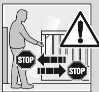
Weisen Sie alle Personen, die die Toranlage benutzen, in die ordnungsgemäße und sichere Bedienung ein. Demonstrieren und testen Sie die mechanische Entriegelung, sowie den Sicherheitsrücklauf. Betätigen Sie dazu die angebaute Schließkantensicherung während des Toraufzulaufes bzw. Toraufzulaufes. Die Toranlage muss den Sicherheitsrücklauf einleiten.
