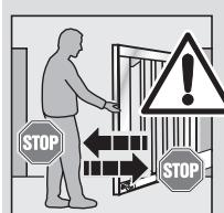
Weisen Sie alle Personen, die die Toranlage benutzen, in die ordnungsgemäße und sichere Bedienung ein. Demonstrieren und testen Sie die mechanische Entriegelung sowie den Sicherheitsrücklauf. Halten Sie dazu das Tor während des Torslaufes mit beiden Händen an. Die Toranlage muss den Sicherheitsrücklauf einleiten.
